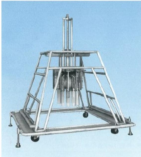
作为 JGOFS（联合全球海洋通量研究）标准海底取样器的沉积物多芯取样器，该设备能够装载多达 8 个独立的采样管，它不仅比现有的箱式取样器容易操作，而且能够大大缩短采样时间。取样管通过附在支撑架上的液压减振器，缓慢地贯入沉积物中，当取样管被提起时，其顶部和底部的盖子将闭合。因此用户可以在不扰动表层沉积物的情况下，稳定地收集所需样品。
