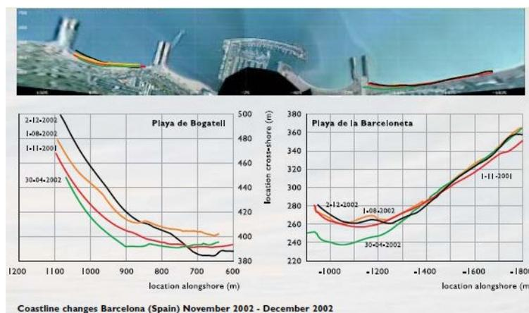
在西班牙的巴塞罗那，海岸线的监测模型被用来评估奥林匹克港的风暴引起的海岸线变化。该模型基于海滩干湿之间颜色变化来导出曝光图像的海岸线的位置。详细的观察表明，在几个不连续的风暴过后，海岸线退缩了几十米。
