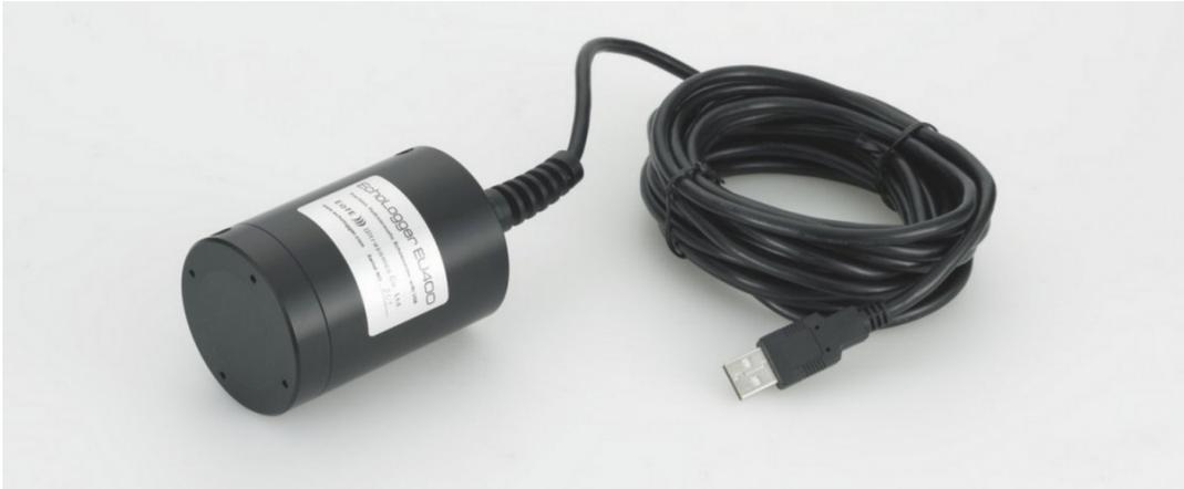
EU400 是市场上仅有的 USB 型回声探测仪。它操作简单，可以在带 USB 接口的电脑或手持设备上即插即测。它可以全剖面测量后向散射数据。它采用 USB 供电，无需外置电源。能够记录全剖面后向散射数据。良好的图形化界面，使其特别适合水底绘图、沉积物监测、桥墩冲刷监测等领域。
