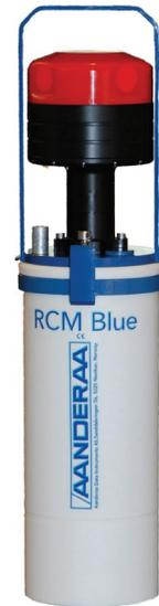
多普勒海流计 RCM blue 采用先进的 ZPulse 技术进行海流和水温的自容式监测。RCM blue 带有蓝牙功能，可通过蓝牙进行仪器配置和数据下载，这样避免了多次布放需要经常打开仪器外壳进行通讯和数据下载，减小了用户的工作量。
